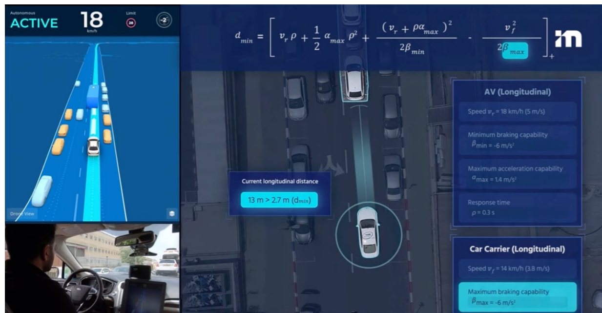
Abbildung 9: Responsibility-Sensitive Safety System mit mathematisch definiertem Sicherheitsrahmen (Mobileye, 2026).
